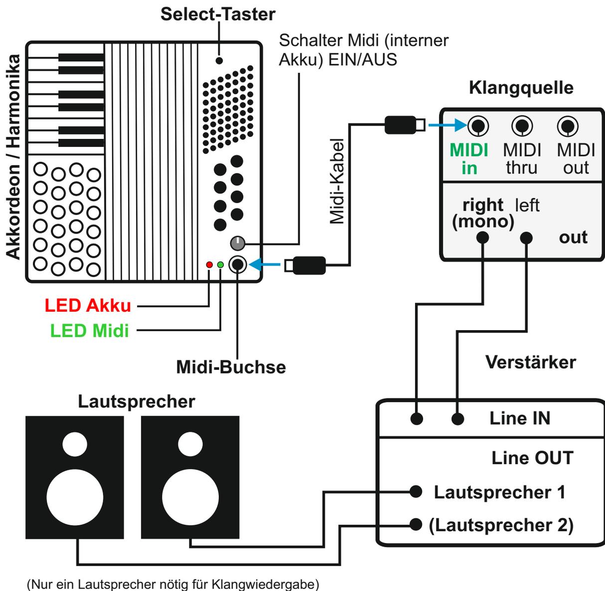
Bei Verwendung Aktiver Lautsprecher (Lautsprecher mit integriertem Verstärker) entfällt ein separater Verstärker. Verbinden Sie Ihre Klangquelle (Line OUT) direkt mit der Aktiv-Box (Line IN).
