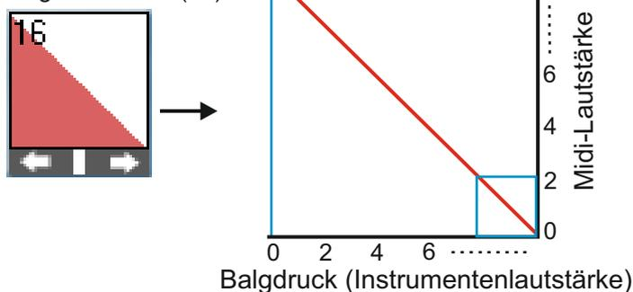
In diesem Beispiel (Kurve 16) wird das Midi leiser, je stärker Sie den Balg betätigen.
