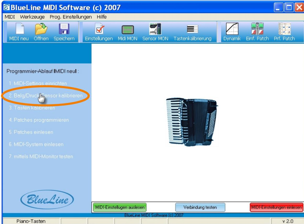
Hier wird der Drucksensor kalibriert (Aussenluftdruck wird als Referenz ermittelt), so dass die Zug-Druck-Umschaltung bei diatonischen Instrumenten sowie die Balgdynamik und Velocity korrekt funktionieren. **Wichtig: während der Kalibration muss das Instrument Drucklos sein ( Instr. auf einen Tisch legen und einige Tasten gedrückt halten (Druckausgleich)!.**
