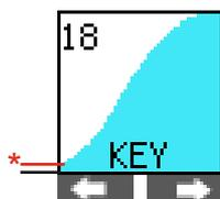
Wir empfehlen für die Tastenanschlagdynamik die Kurve 18 (\*und diese ev. ganz leicht mit der Maus nach oben ziehen).
