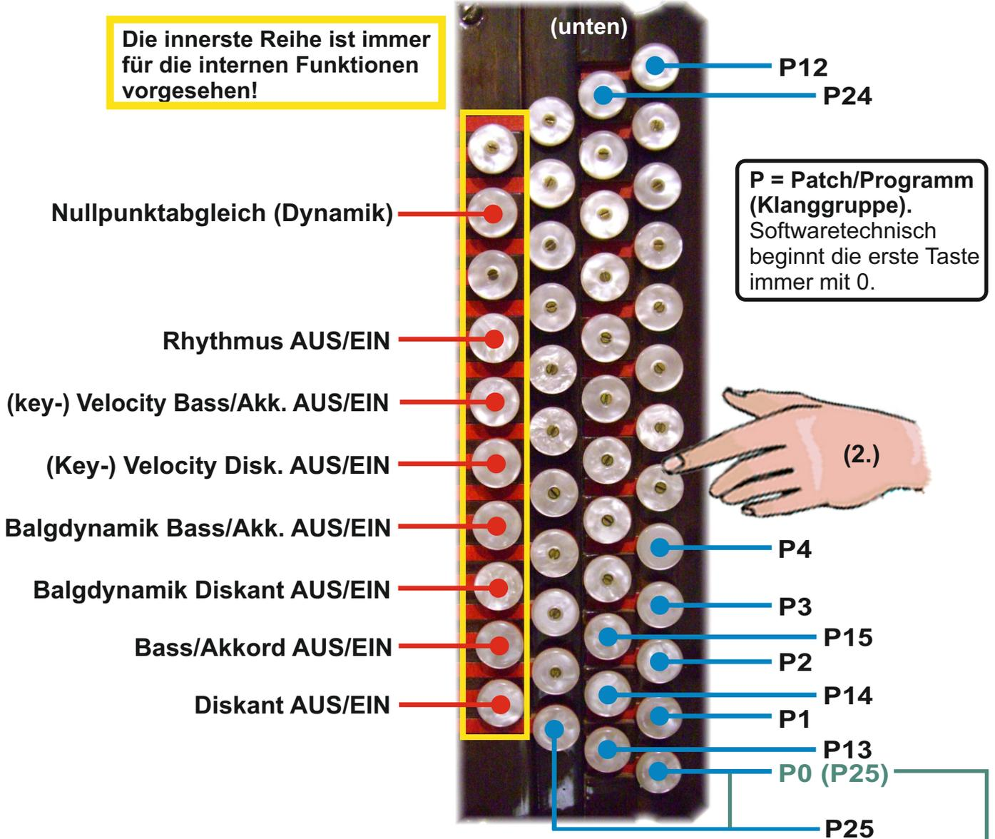
Die Tastenbelegung kann mit der BlueLine-Anwendersoftware beliebig geändert werden!
