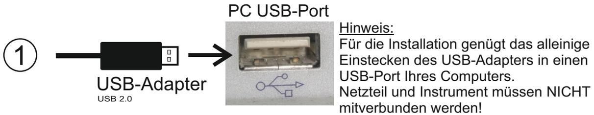
Nach dem Einstecken des USB-Adapters in den PC-USB-Port erkennt der Computer die neue Hardware. Installieren Sie diese nun wie folgt:
