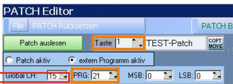
Zum besseren Verständnis zeigen wir hier nochmal die Tastenfolge der Instrumente. Die Taste Nr.1 in der Software ist also die 2.Taste Ihres Instrumentes, da die Zählfolge ja mit 0 beginnt. Das Programm 21 liegt demnach auf der 2. Taste des Instrumentes.
