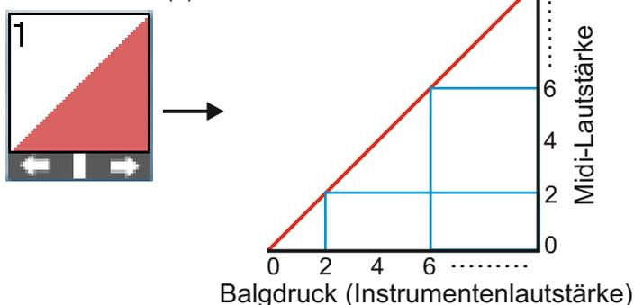
In diesem Beispiel (Kurve 0) wird das Midi linear lauter, je stärker Sie den Balg betätigen.
