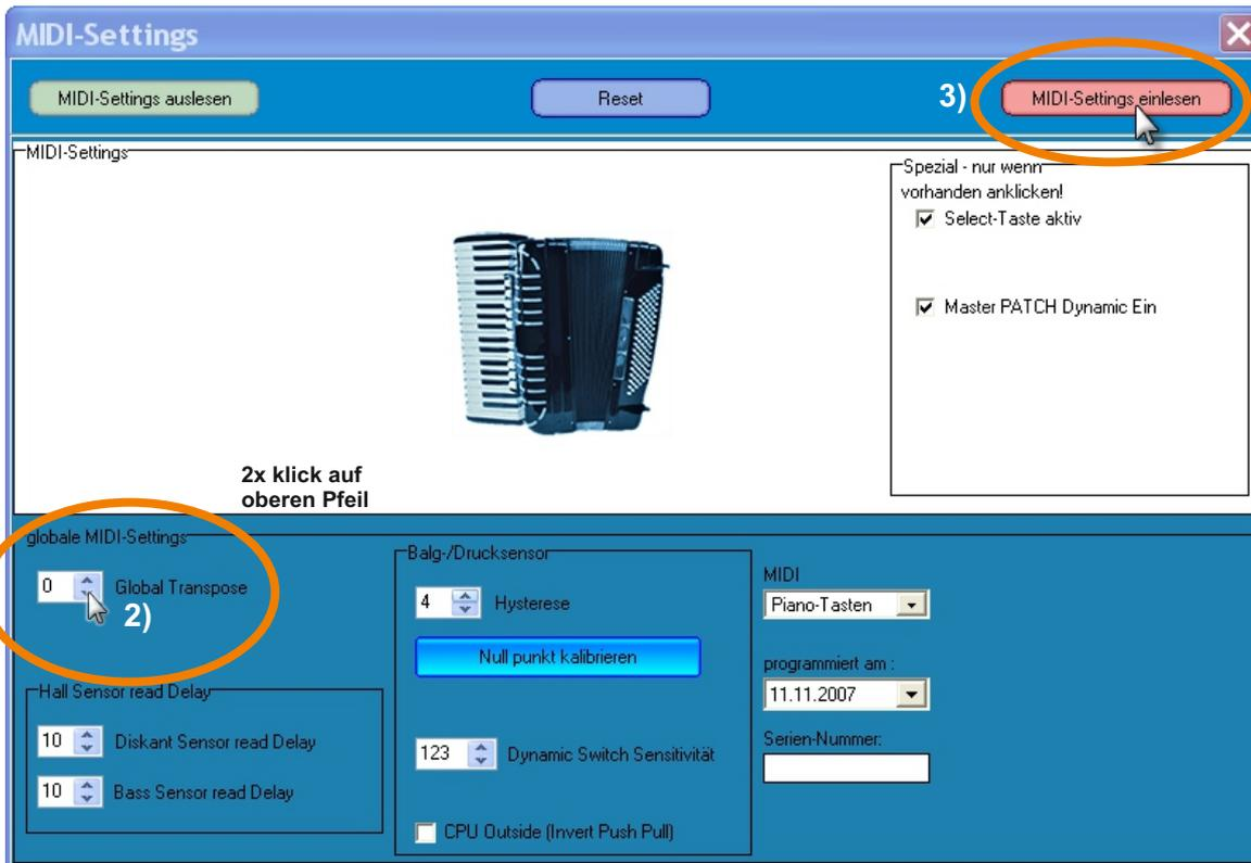
2) Bei der Funktion "Global Transpose" entweder auf den oberen oder unteren Pfeil klicken. Die Tonlage Ihres Instrumentes (bzw. Ihres Midis) wird mit dem oberen Pfeil je einen Halbtonschritt nach oben, mit dem unteren Pfeil in Halbtonschritten (-) nach unten transponiert.
