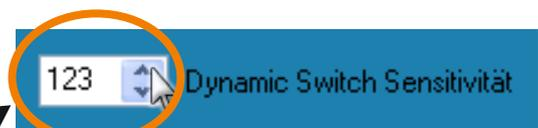
Mit Klick auf die beiden Pfeile kann der Wert für die Intensität entweder nach oben (max. Wert: 125) oder nach unten korrigiert werden. Der Wert 123 ist aber ein sehr guter Wert, und sollte am Besten so beibehalten werden.
