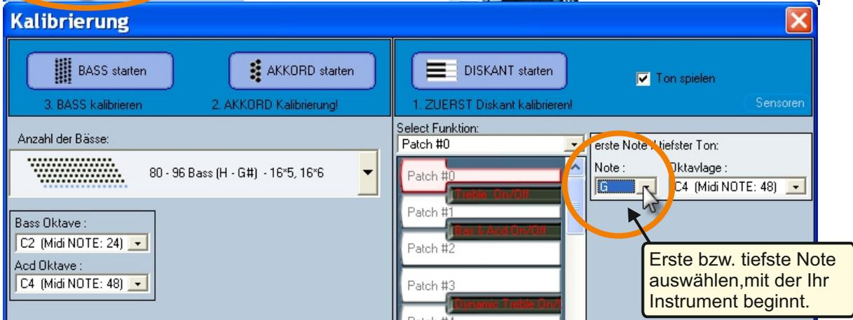
Bei der Tastenkalisierung werden den jeweiligen Sensoren durch Tastendruck auf Ihrem Instrument der entsprechende Ton zugeordnet. Die Tastenkalisierung beginnt immer zuerst auf der Diskantseite (1). Danach werden die Akkorde (2) und zuletzt die Bässe (3) kalibriert. Reihenfolge unbedingt einhalten!
